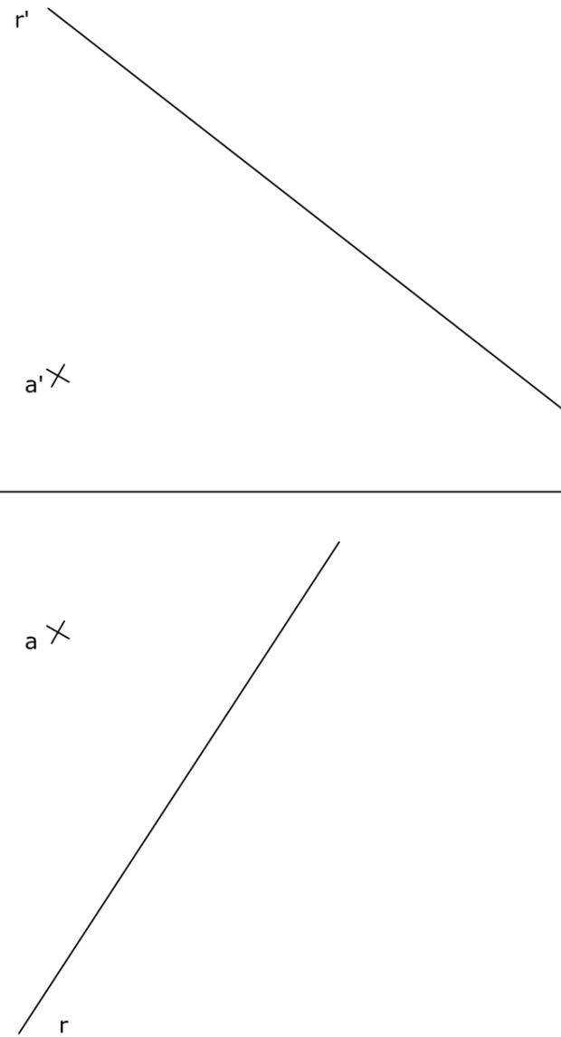
BLOQUE 2. EJERCICIO 1. - DIÉDRICO. Dado el plano P, se pide dibujar las proyecciones del triángulo equilátero contenido en dicho plano y del cual se conoce la proyección vertical de uno de sus vértices ( $a'$ ), que otro de los vértices tiene la misma cota y que el lado del triángulo mide 50 mm. El triángulo se encuentra totalmente en el primer cuadrante.
